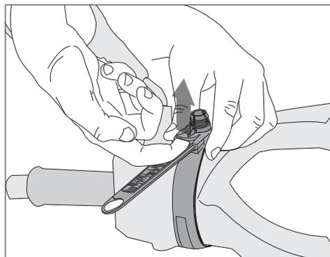
Per rimuovere la cinghia di fissaggio sollevare la linguetta di sgancio serrando con due dita la base del supporto.
