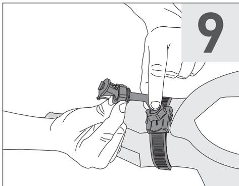
Fissare il supporto orientandolo nella posizione ottimale (Il supporto è utilizzabile anche senza astina orientabile, agganciando la custodia direttamente al supporto della prima ghiera).
