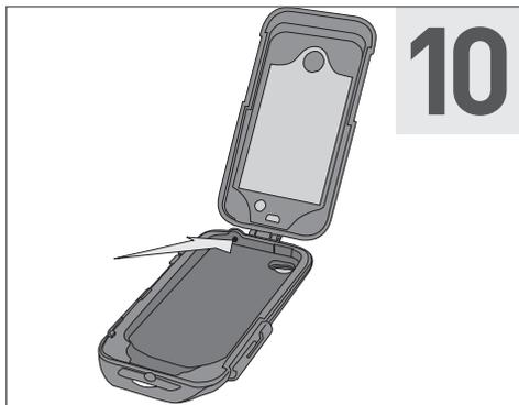
Utilizzare l'apposita feritoia per il passaggio dei cavi di alimentazione (se necessari).
